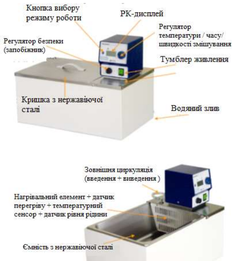
Рис. 2.4.2 – Схема циркуляційного термостата WCB6/11
