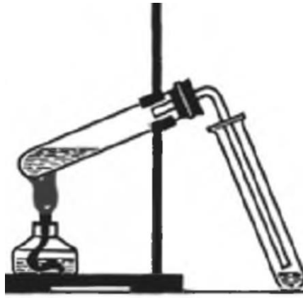
Рис. 8.2. Установка для отримання оцтової кислоти
