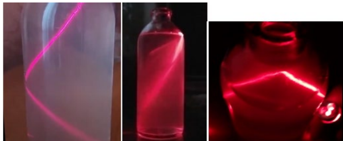
Рис.3. Відбиття світла лазера від мильної води
