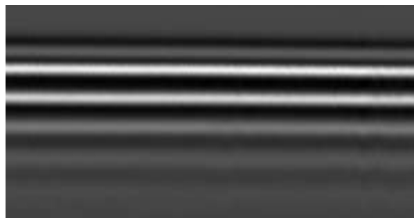
Рисунок 4. Радарограма армованого цементобенного шару товщиною 20 см.
