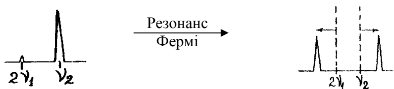
Рис. 11.3 – Вплив резонансу Фермі на ІЧ-спектр
